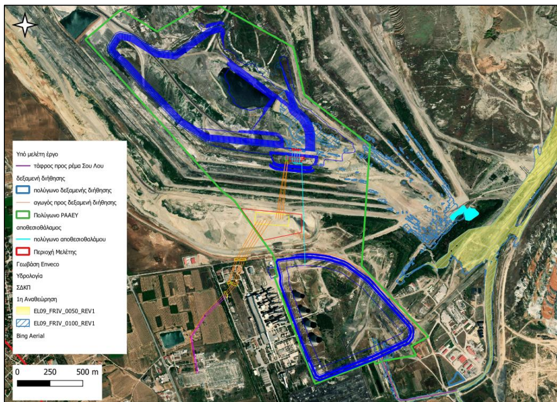
Σχήμα 8.13-3 Χωροθέτηση έργου και ζώνες πλημμύρας για περίοδο επαναφοράς T=50 έτη και T=100 έτη (στοιχεία 1 ης αναθεώρησης).
