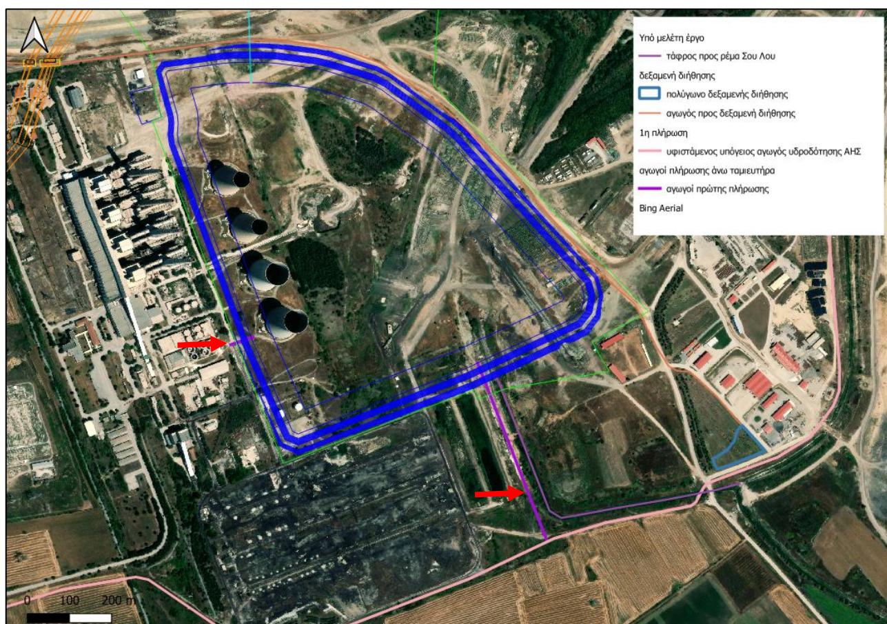
Σχήμα 6.1-11 Αναθεωρημένος σχεδιασμός και εναλλακτικές λύσεις για την σύνδεση με τον υφιστάμενο αγωγό μεταφοράς νερού από τον ταμιευτήρα Πολυφύτου, όπως έχουν επισημανθεί με κόκκινο βέλος.
